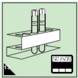
将摇匀后的试剂放在试管架中，静置使其反应并准确计时 15 分钟。（反应中试管会发热，可在最后 5 分钟时间至于水浴中冷却至室温）
