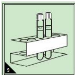
消解时间结束，消解器进行降温，手拿管盖取出试管，放入试管架中置于通风处进行冷却，待试管降至室温左右方可进行下一步。
