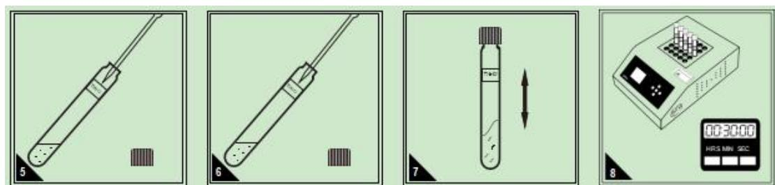
使用移液管或移液枪准确移取一定体积的蒸馏水加入到比色消解管 A 的试管内, 制成空白样。
