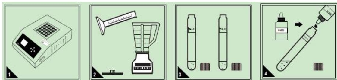
打开多功消解仪进行预热,设定程序加热温度 125 °C 加热时间 30 分钟。
