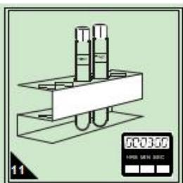
将摇匀后的试剂放在试管架上，静置使其反应并准确计时 2 分钟。
