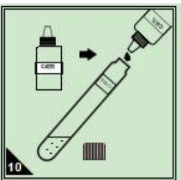
在冷却好的消解管 A 中，分别加入 2 滴 C 试剂，摇匀。
