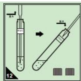
反应结束后取出对应数量的比色消解管 D（蓝盖试管），打开盖子，从管 A 中准确移取 1.0ml 试剂至管 D 中，拧紧管盖上下摇匀，记录试管上的编码。
